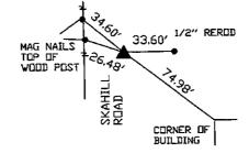
N 1/4 COR., SEC. 12, T.85N. R.1V. OF THE 5TH P.M. FOUND 3/4" REROD BENT PLACED 5/8" REROD W/ORANGE PLASTIC CAP MARKED "WEBER PLS 15084"
