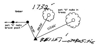
SW CORNER NE-NE SEC. 15 T.86N. R.1W. OF THE 5TH P.M. PLACED 5/8' STEEL REROD W/DRANGE PLASTIC CAP MARKED "WEBER PLS 15084"
